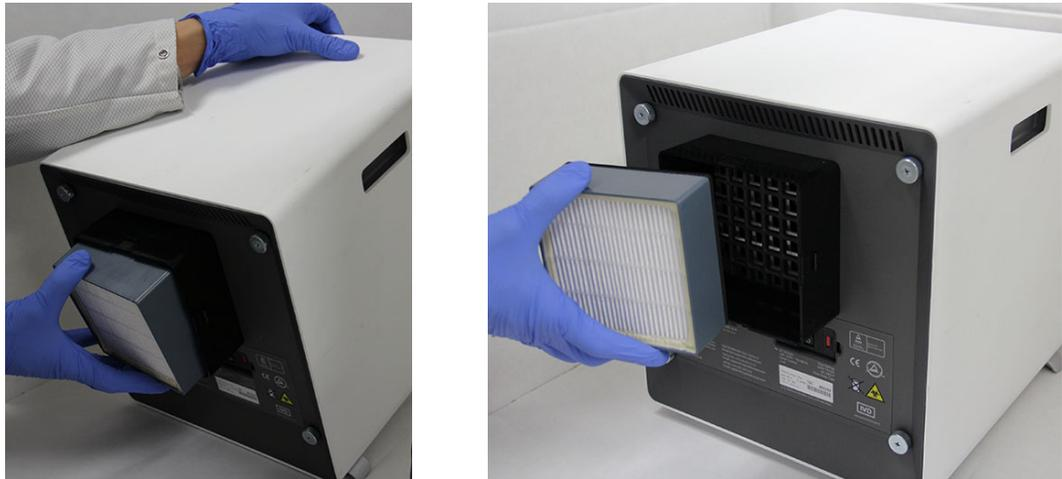
Figura 9-28. Rimozione del filtro HE
