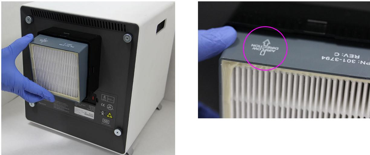
Figura 9-29. Sostituzione del filtro HE
