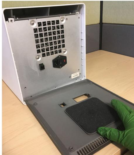
**Figura 9-16. Sostituzione del filtro in schiuma nel precedente GX-IV**
