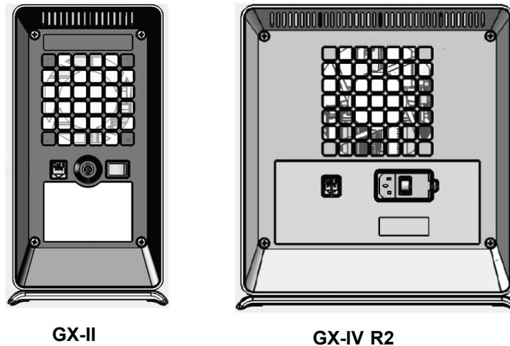
**Figura 9-12. Filtri di tipo vecchio (è necessario scollegare lo strumento dalla sorgente di alimentazione)**
