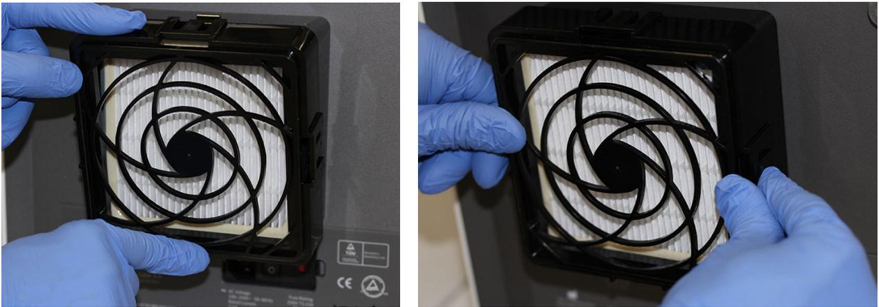
**Figura 9-30. Sostituzione della griglia di sostegno del filtro HE**
