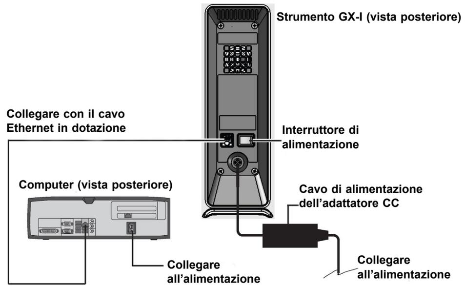
Figura 2-1. Collegamento dello strumento GX-I al computer desktop
