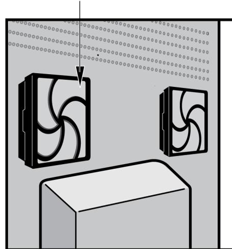
**Figura 9-20. Filtro sostitutivo e griglia di protezione montati**
