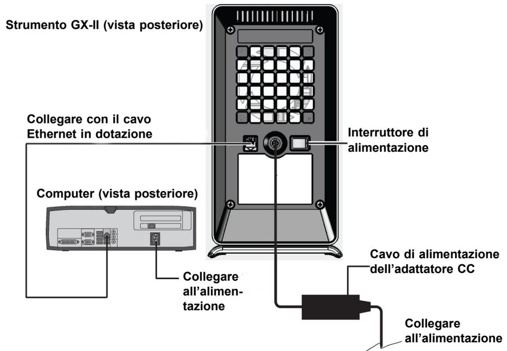
Figura 2-2. Collegamento dello strumento GX-II al computer desktop
