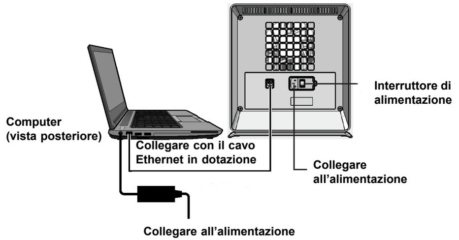
Figura 2-7. Collegamento dello strumento GX-IV al computer portatile
