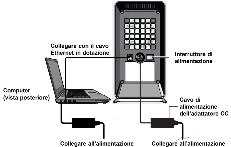
Figura 2-6. Collegamento dello strumento GX-II al computer portatile
