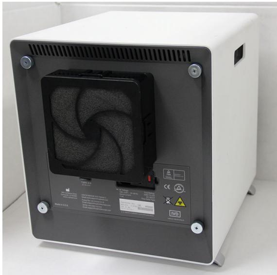
**Figura 9-24. Strumento GX-IV posizionato per accedere al filtro**
