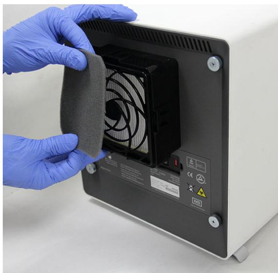
**Figura 9-26. Rimozione del prefiltra**
