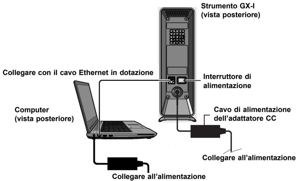
Figura 2-5. Collegamento dello strumento GX-I al computer portatile
