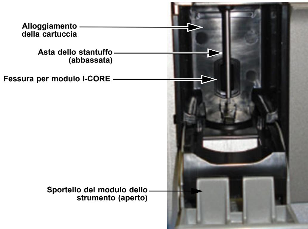
**Figura 9-5. Asta dello stantuffo abbassata nell'alloggiamento della cartuccia**
