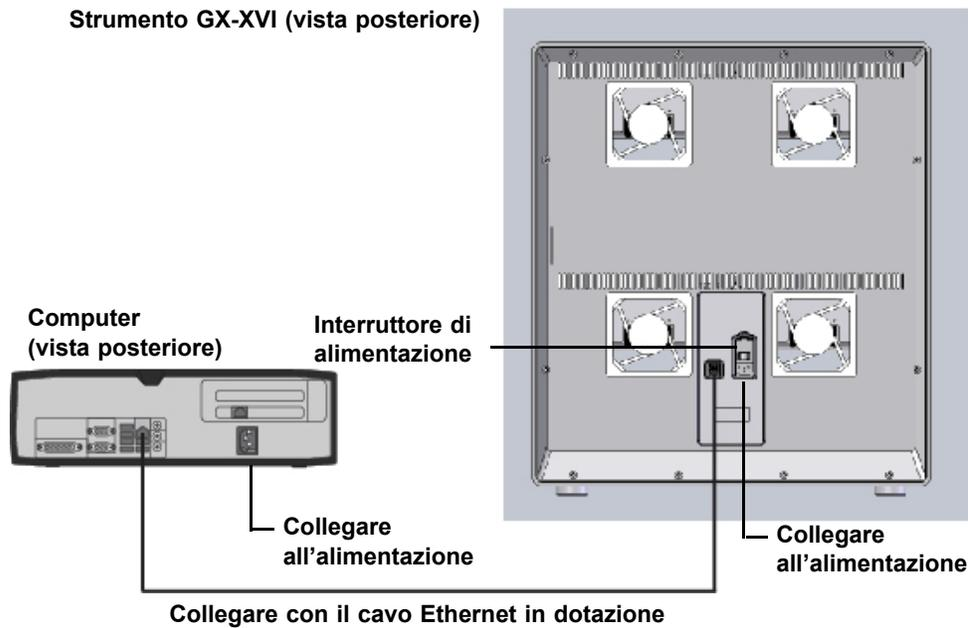
Figura 2-4. Collegamento dello strumento GX-XVI al computer desktop
