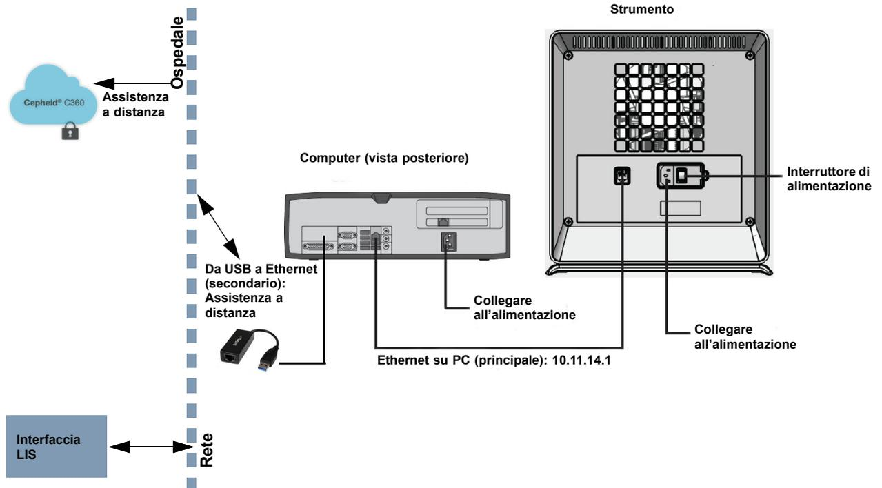
Figura 2-11. Collegamento dello strumento GX-IV a C360
