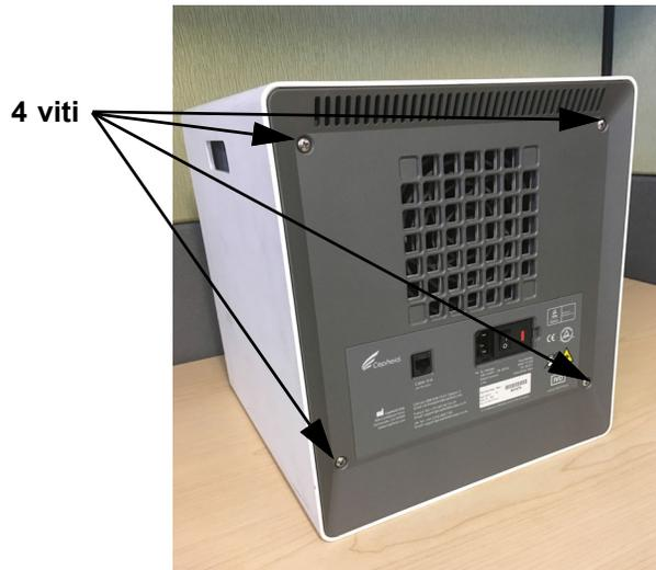
**Figura 9-14. Viti del pannello posteriore sul precedente GX-IV**
