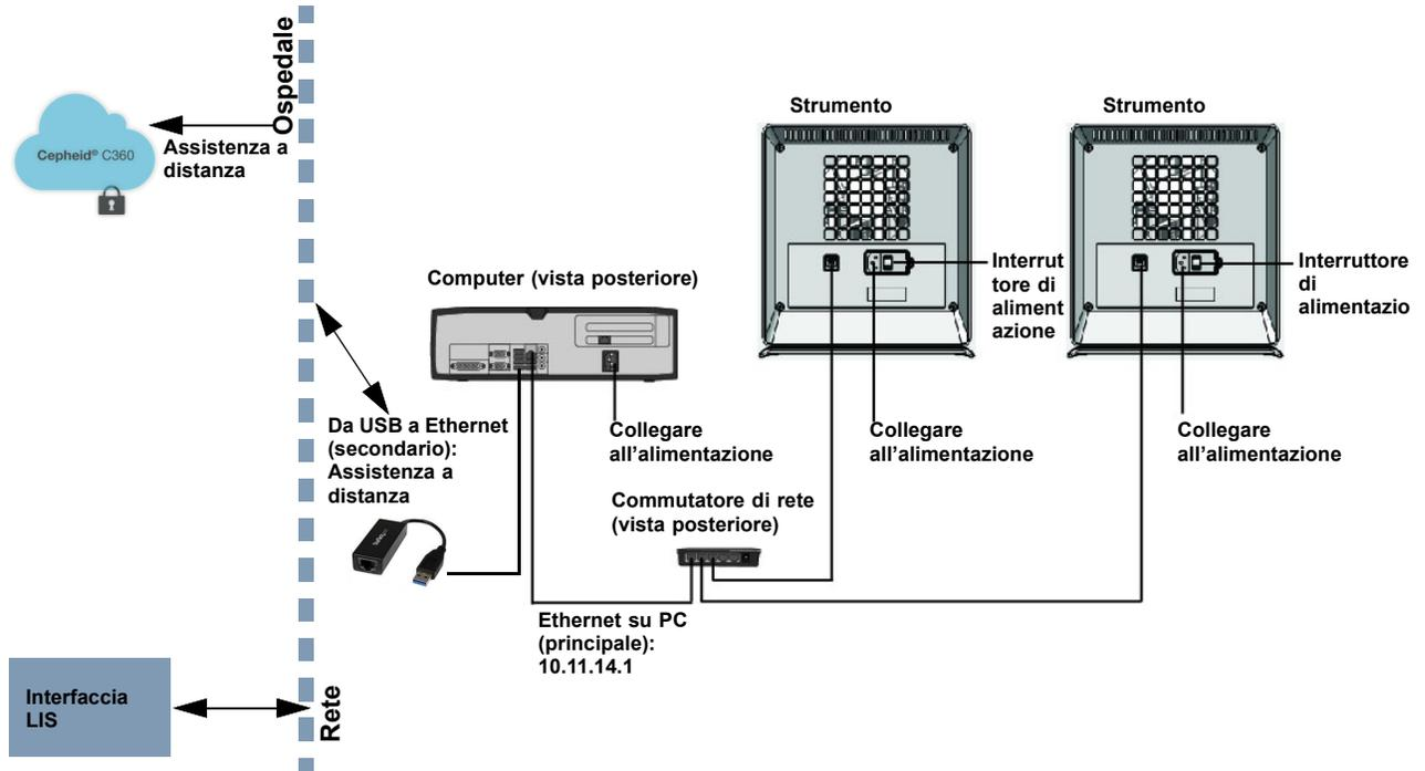
Figura 2-12. Collegamento di più strumenti GX-IV a C360
