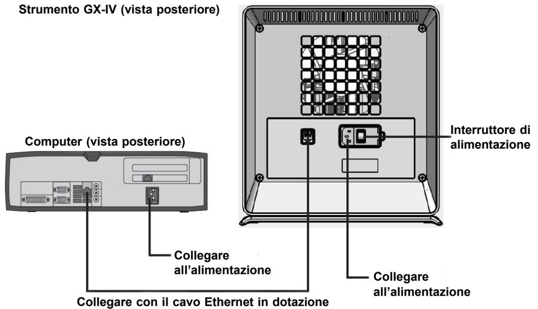
Figura 2-3. Collegamento dello strumento GX-IV al computer desktop
