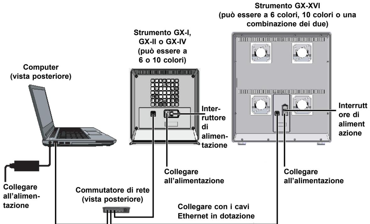
Figura 2-10. Collegamento di più strumenti al computer portatile
