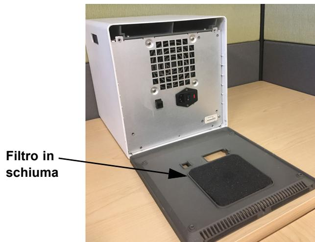
**Figura 9-15. Filtro in schiuma nel precedente GX-IV**
