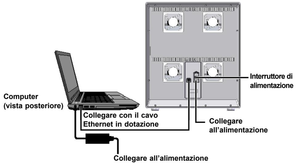
Figura 2-8. Collegamento dello strumento GX-XVI al computer portatile
