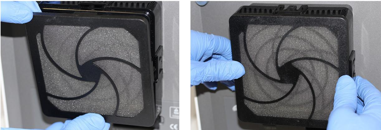
**Figura 9-31. Sostituzione del prefiltra e della relativa griglia di sostegno**
