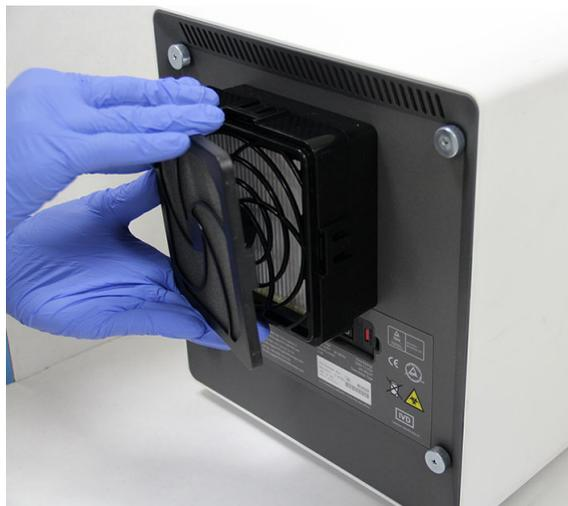
**Figura 9-25. Rimozione della griglia di sostegno del prefiltra**
