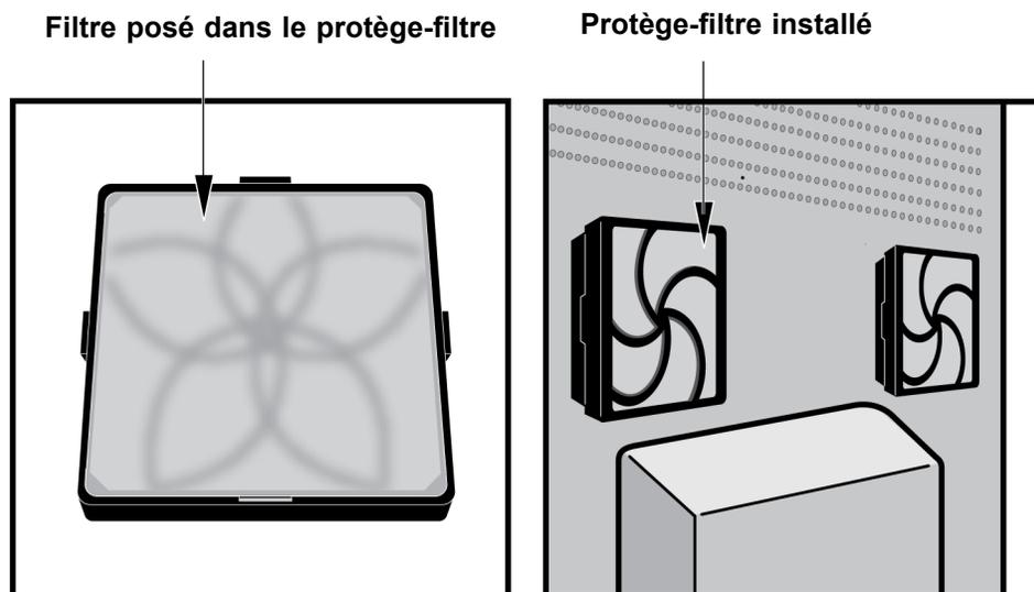
Figure 9-20. Filtre de rechange et protège-filtre installés
