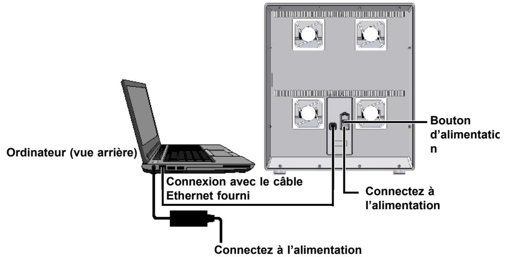
Figure 2-8. Connexion de l'instrument GX-XVI à l'ordinateur portable
