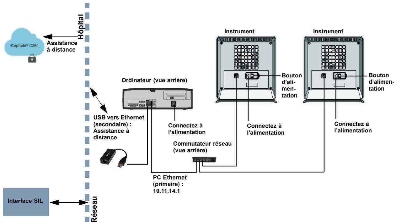
Figure 2-12. Connexion de plusieurs instruments GX-IV au C360
