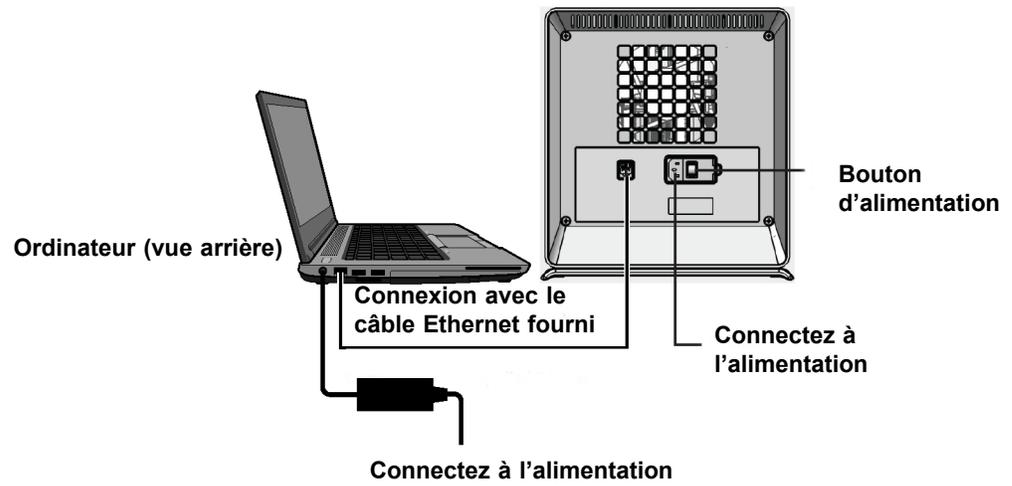
Figure 2-7. Connexion de l'instrument GX-IV à l'ordinateur portable
