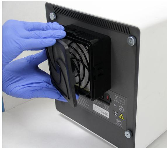
**Figure 9-25. Retrait du dispositif de maintien du préfiltre**
