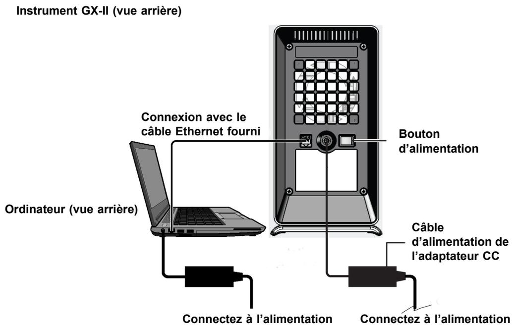
Figure 2-6. Connexion de l'instrument GX-II à l'ordinateur portable
