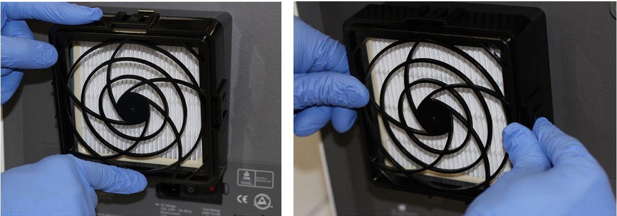
**Figure 9-30. Remise en place du dispositif de maintien du filtre HE**
