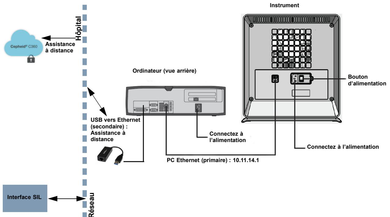
Figure 2-11. Connexion de l'instrument GX-IV au C360
