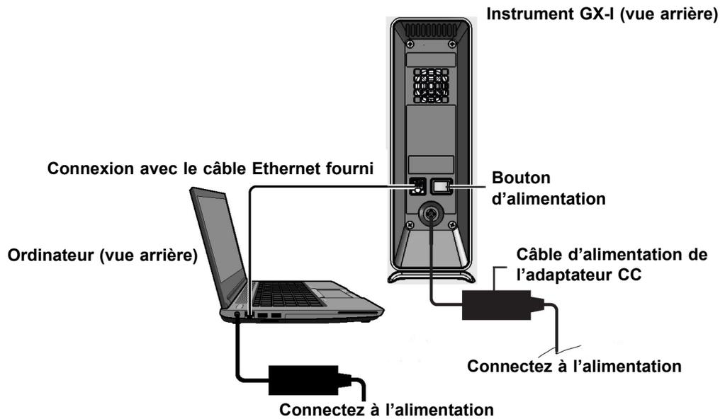
Figure 2-5. Connexion de l'instrument GX-I à l'ordinateur portable
