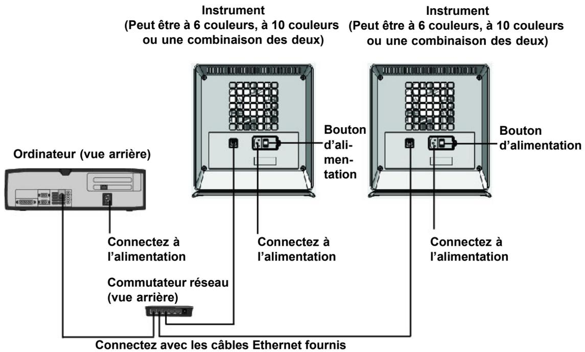
Figure 2-9. Connexion de plusieurs instruments GX-IV à l'ordinateur de bureau
