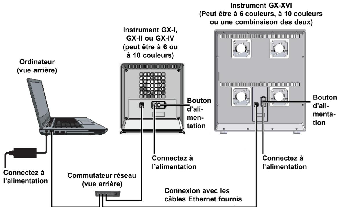
Figure 2-10. Connexion de plusieurs instruments à l'ordinateur portable
