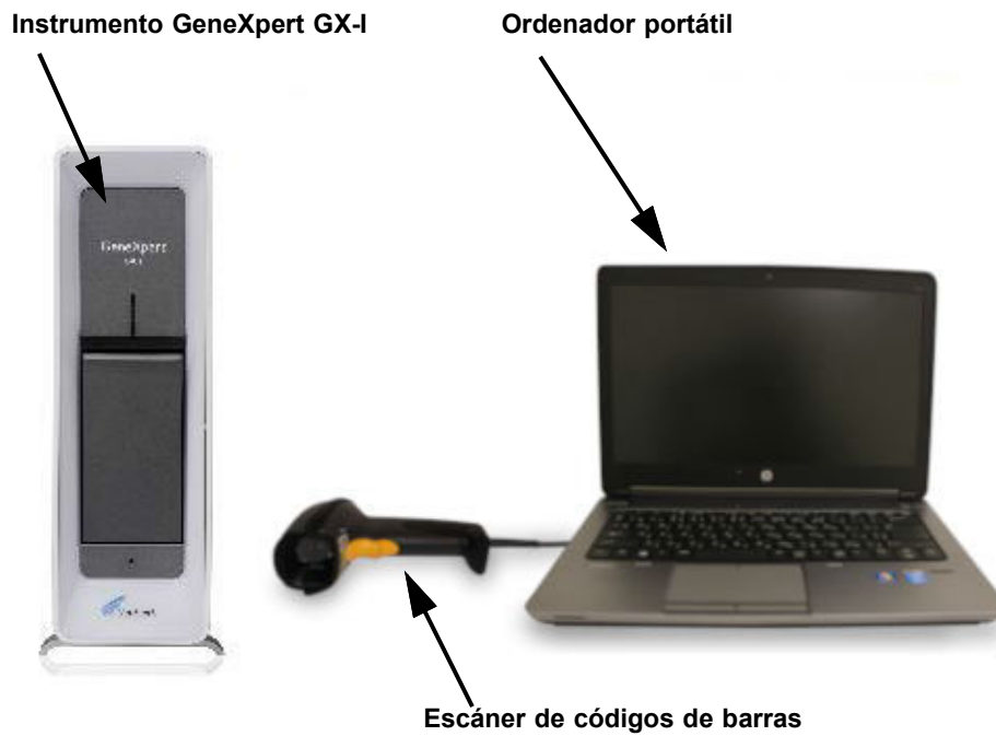
Figura 1-2. Componentes de hardware del GeneXpert GX-I (mostrados con el ordenador portátil)
