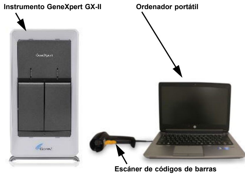
Figura 1-4. Componentes de hardware del GeneXpert GX-II (mostrados con el ordenador portátil)
