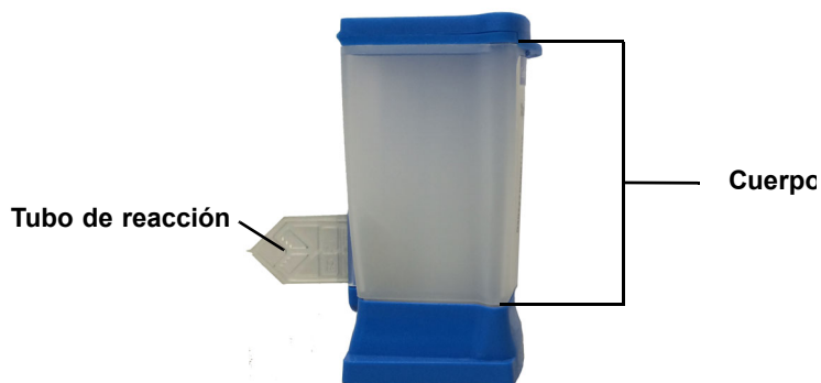
Figura 5-31. Cartucho donde puede verse el cuerpo y el tubo de reacción
