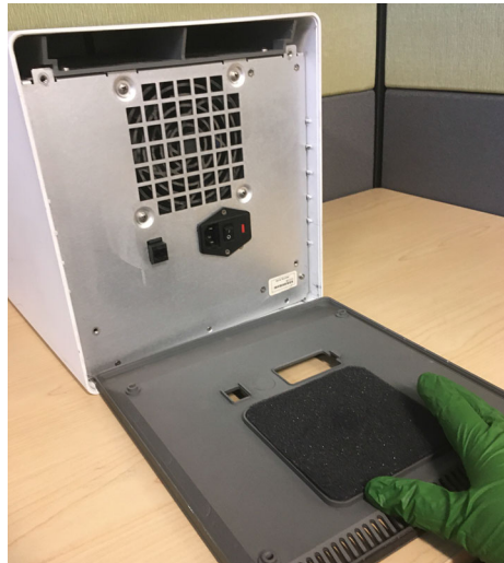
Figura 9-16. Sustitución del filtro de espuma en los modelos antiguos del GX-IV
