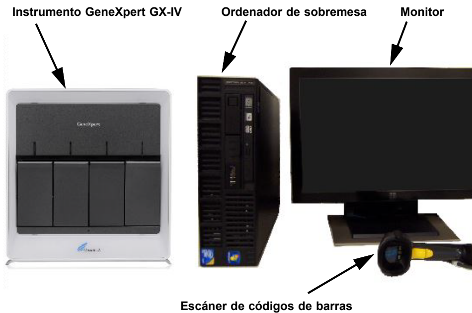
Figura 1-7. Componentes de hardware del GeneXpert GX-IV (mostrados con el ordenador de sobremesa)
