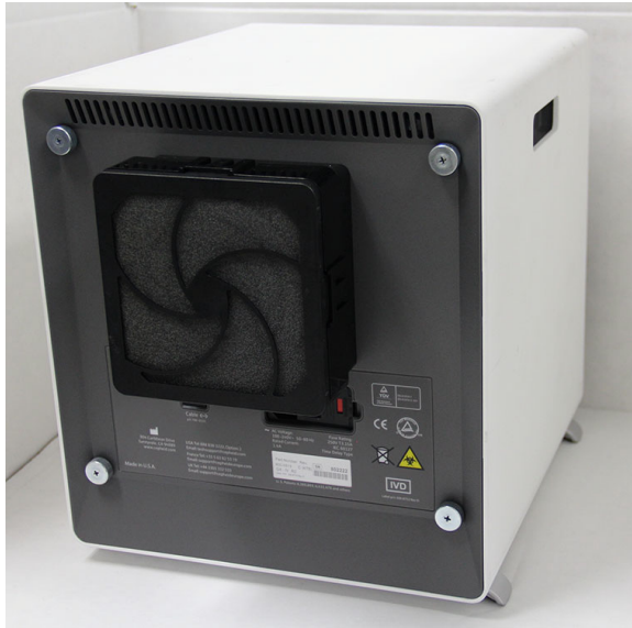
Figura 9-24. Instrumento GX-IV colocado para acceder al filtro
