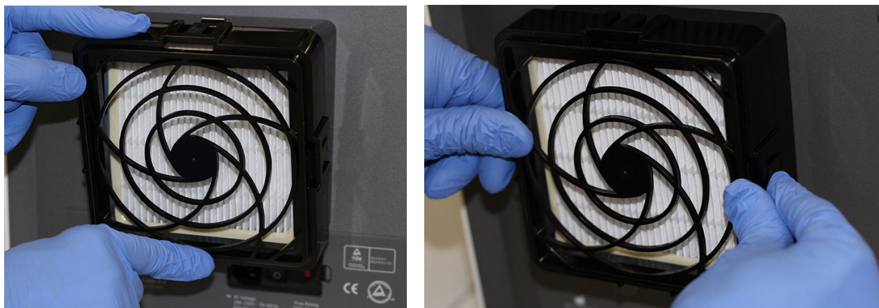
Figura 9-30. Cambio del retén del filtro HE
