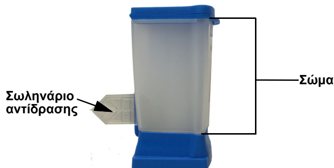
Εικόνα 5-31. Φύσιγγα στην οποία παρουσιάζεται το σώμα και το σωληνάριο αντίδρασης
