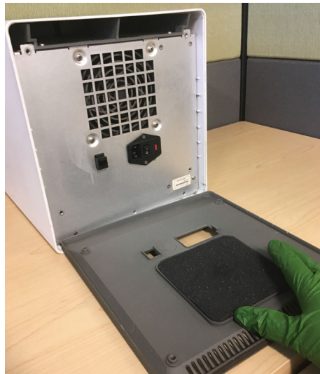
Εικόνα 9-16. Επανατοποθέτηση φίλτρου αφρώδους υλικού σε παλαιότερο GX-IV
