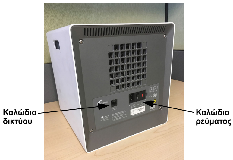
Εικόνα 9-13. Θέσεις καλωδίου δικτύου και καλωδίου ρεύματος σε παλαιότερο GX-IV
