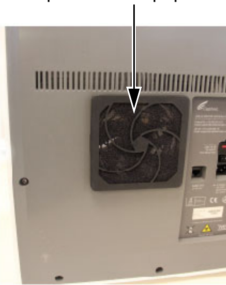
Εικόνα 9-23. Αντικατάσταση του φίλτρου και του προστατευτικού
