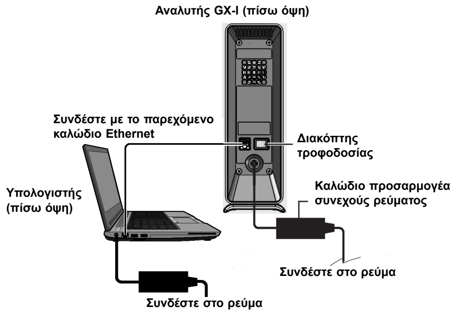
Εικόνα 2-5. Σύνδεση του αναλυτή GX-I σε φορητό υπολογιστή
