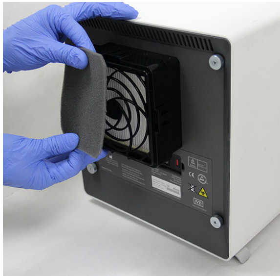
Εικόνα 9-26. Αφαίρεση του προφίλτρου
