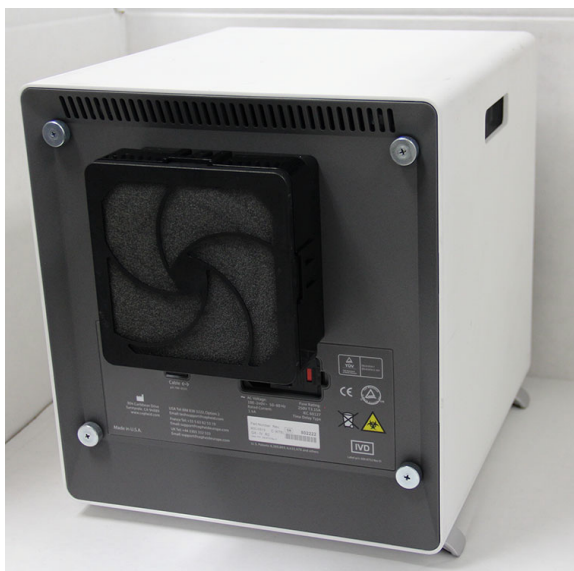
Εικόνα 9-24. Αναλυτής GX-IV τοποθετημένος για πρόσβαση στο φίλτρο
