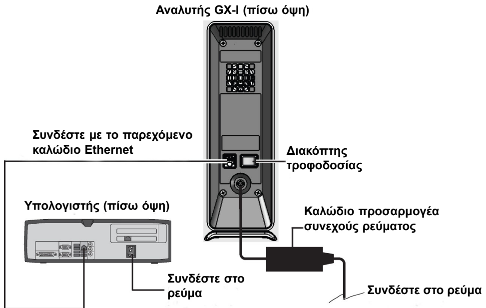
Εικόνα 2-1. Σύνδεση του αναλυτή GX-I σε σταθερό υπολογιστή
