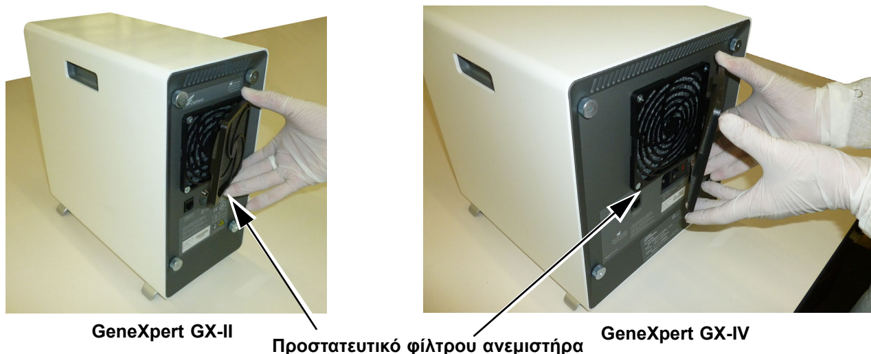
Εικόνα 9-9. Αφαίρεση του προστατευτικού του φίλτρου του ανεμιστήρα
