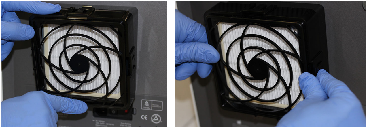
Εικόνα 9-30. Αντικατάσταση του συγκρατητήρα φίλτρου HE
