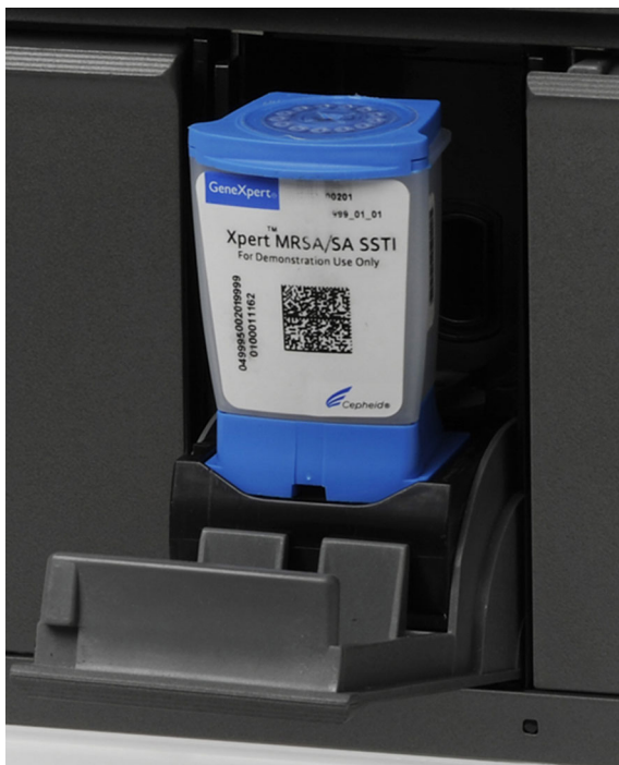
Εικόνα 5-33. Φύσιγγα GeneXpert, τοποθετημένη στη γωνία του δαπέδου της υποδοχής της υπομονάδας
