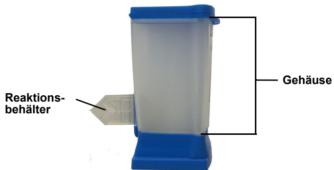
Abbildung 5-31. Kartusche mit Gehäuse und Reaktionsbehälter
