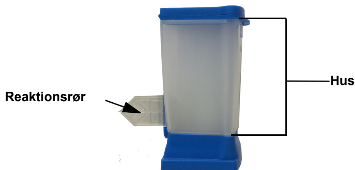
Figur 5-31. Kasette med visning af hus og reaktionsrør
