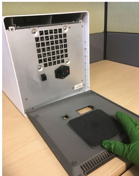
Figur 9-16. Udskiftning af skumfilter i ældre GX-IV
