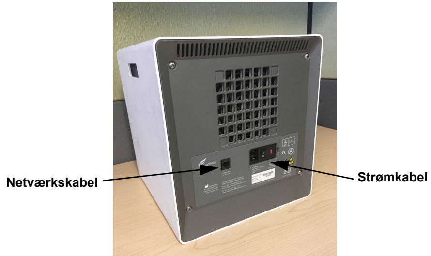
Figur 9-13. Netværkskabel- og strømkabelplaceringer på ældre GX-IV
