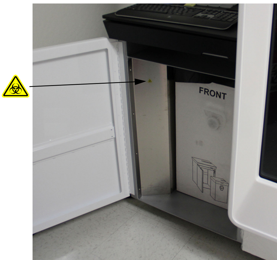
Figura 8-2. Localização da etiqueta de risco biológico no interior da estrutura do recipiente de resíduos
