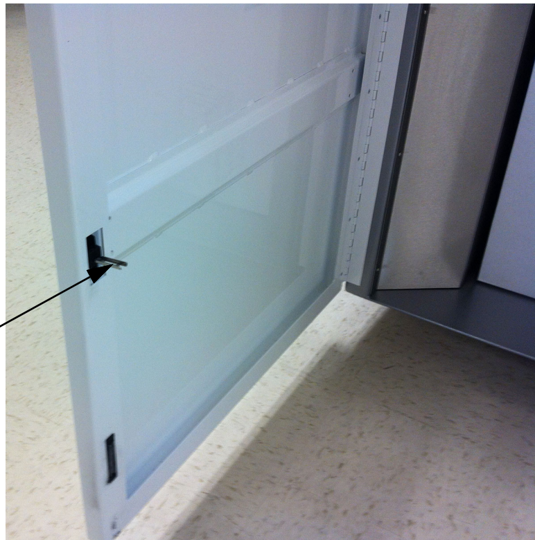
Figura 9-46. Trinco metálico na porta do recipiente de resíduos
