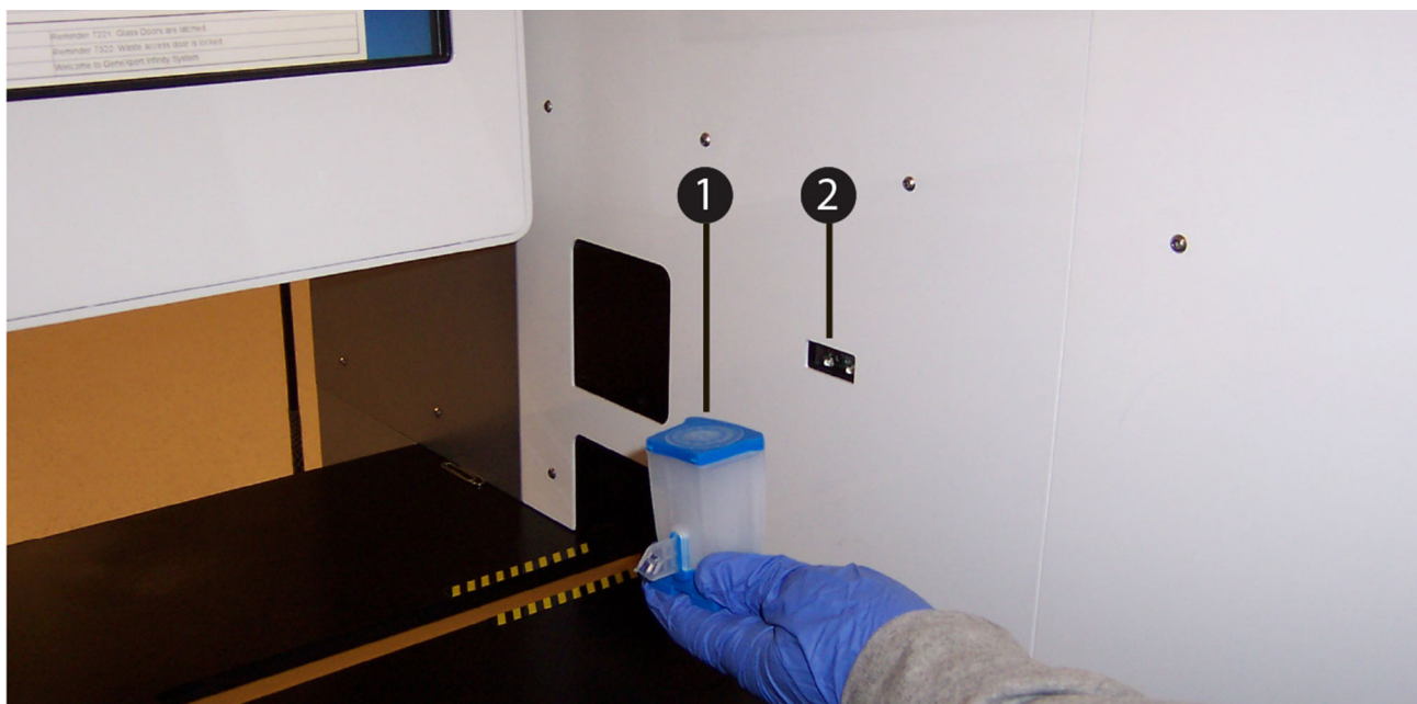
図 5-180. キオスクバーコードスキャナによるカートリッジバーコードのスキャン
