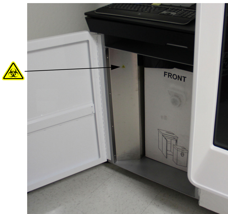
図 8-2. 廃棄物コンテナハウジング内の生物学的リスクラベルの場所
