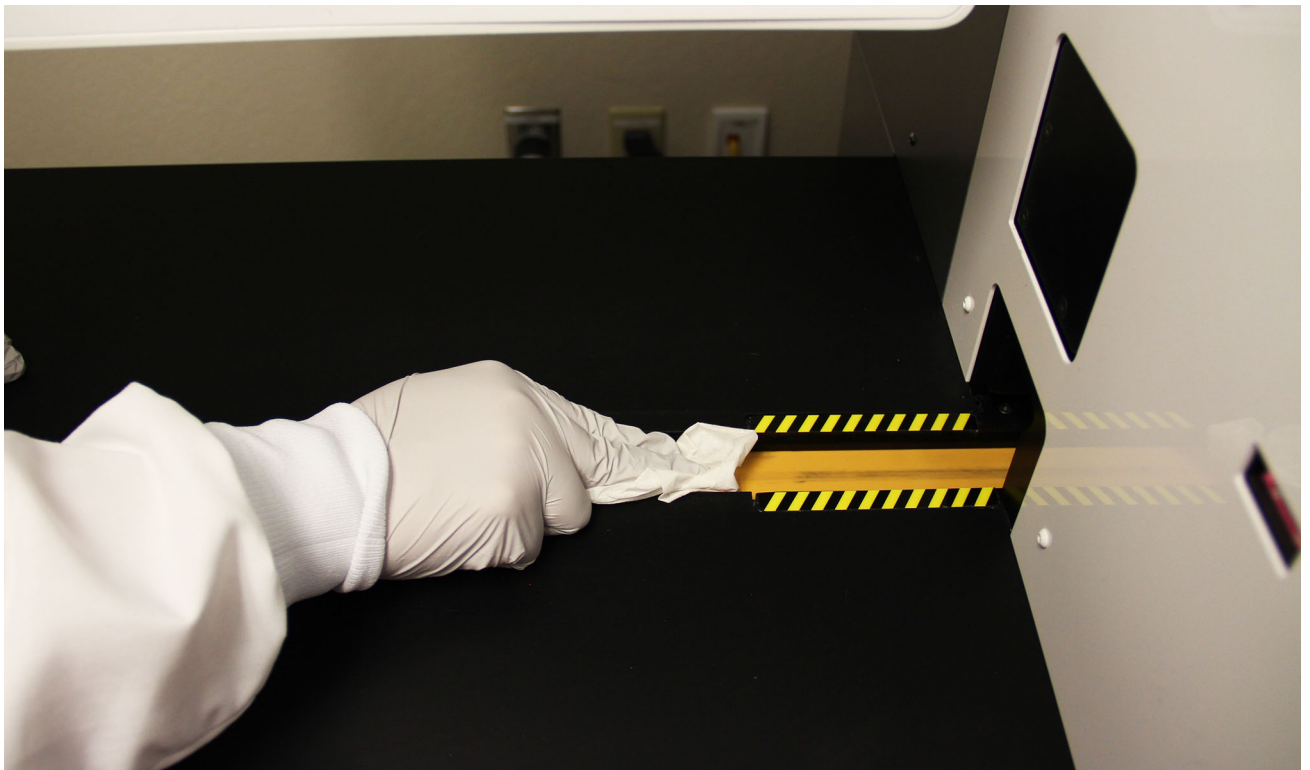
図 9-7. キオスクの上部からのコンベヤーベルトの短時間清掃
