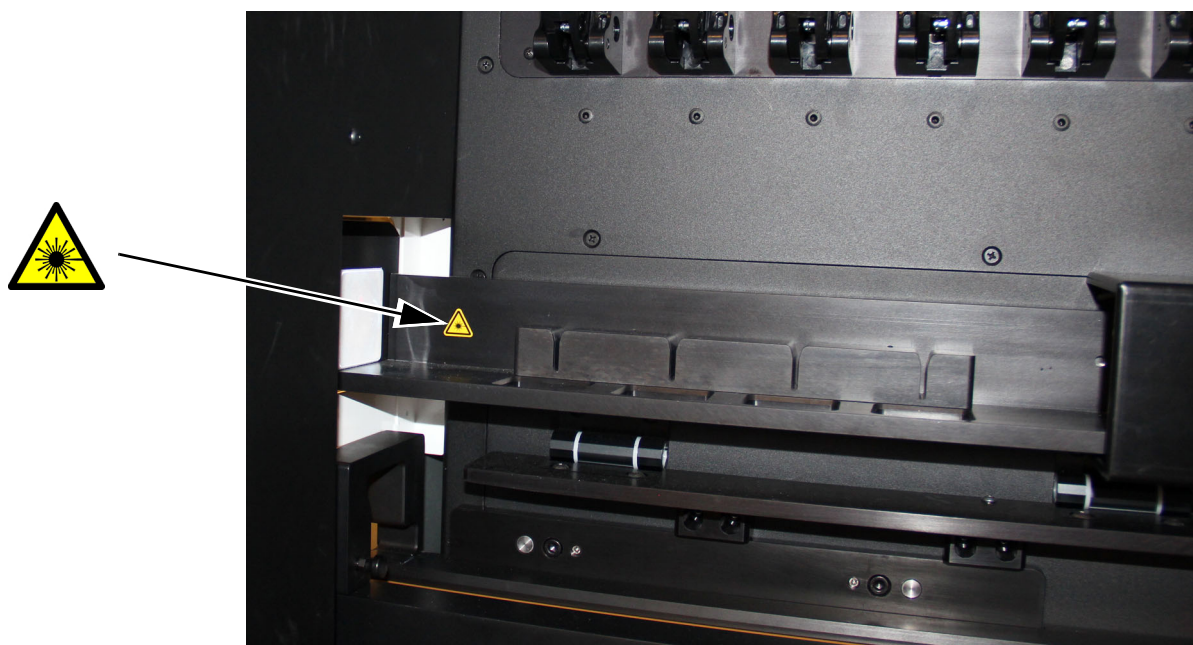
図 8-1. シャトル上のクラス 1 レーザーラベルの場所
