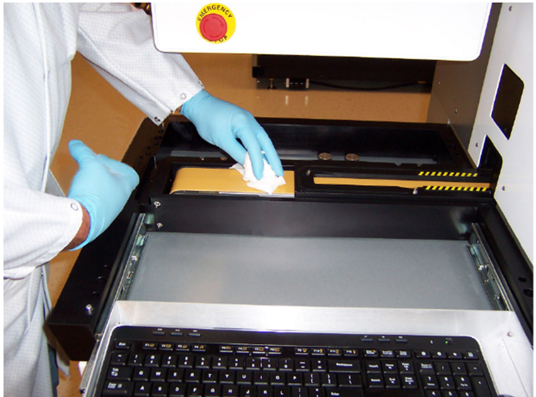
図 9-16. コンベアーベルトの拭き取り
