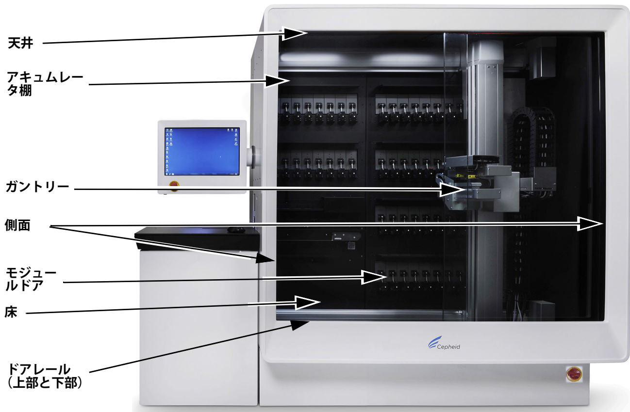
図 9-6. 影響を受ける可能性のある機器表面の清掃
