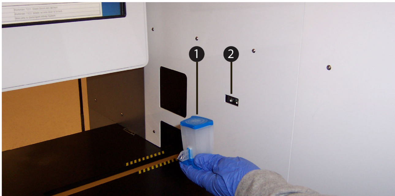
Gambar 5-175. Memindai Kode Batang Kartrid menggunakan Pemindai Kode Batang Bilik
