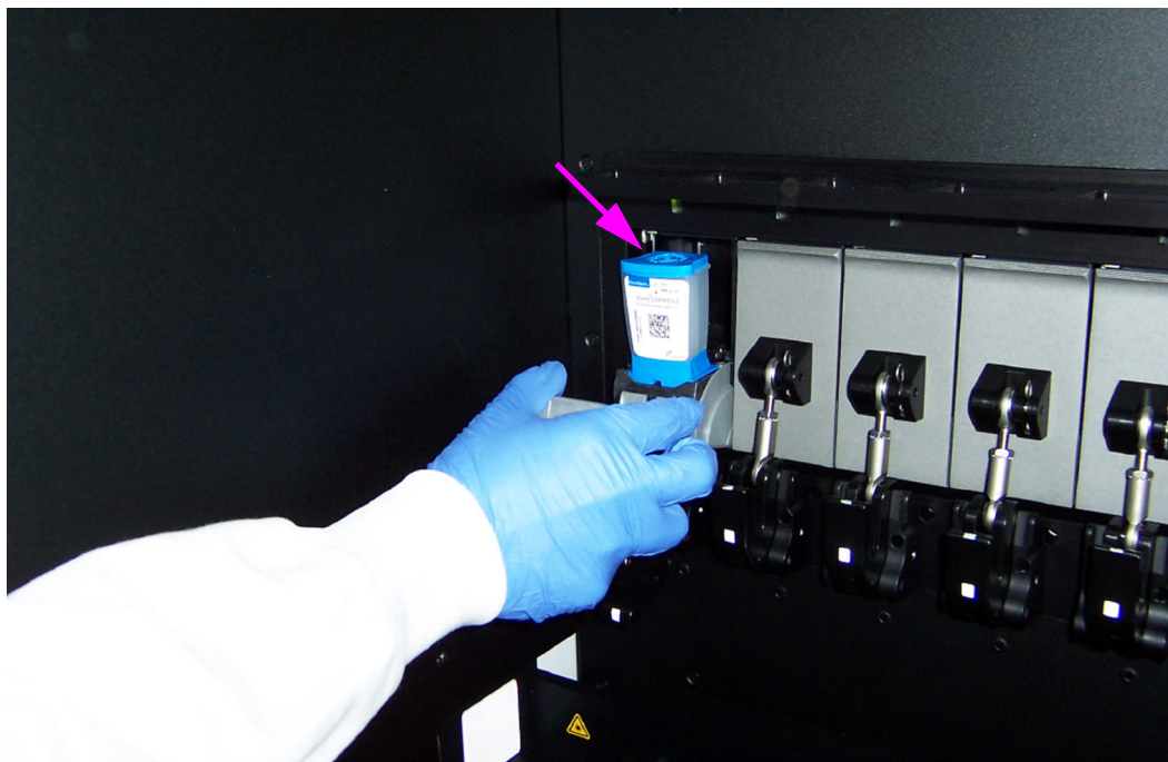
Gambar 5-111. Memuatkan Kartrid ke dalam Modul GeneXpert
