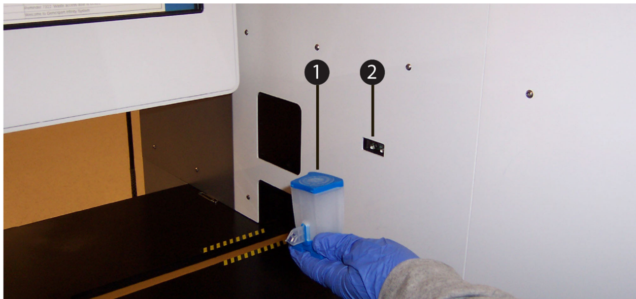
Gambar 5-33. Memindai Kode Batang Kartrid menggunakan Pemindai Kode Batang Bilik
