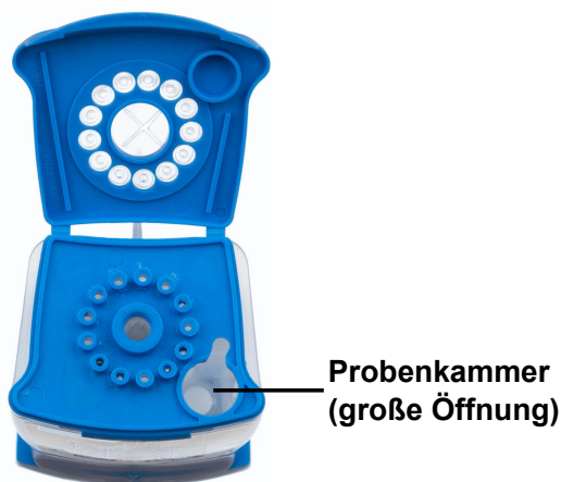
Abbildung 5. Xpert Xpress CoV-2 plus-Kartusche (Draufsicht)
