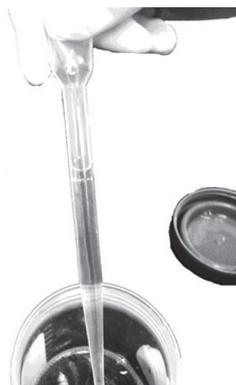
**Figura 4. Aspiración hasta la línea de la pipeta**
