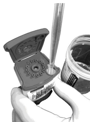
Ilustracja 5. Przenoszenie odkażonej, upłynnionej próbki do komory na próbkę kartridża
