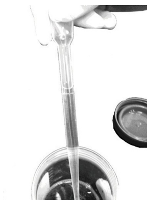
Ilustracja 4. Aspirowanie do linii na pipecie
