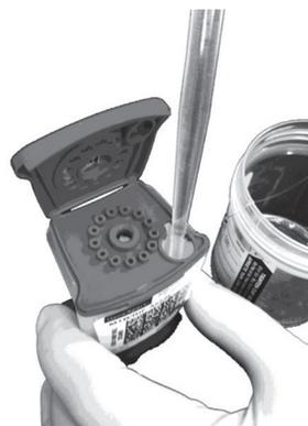
**Figura 5. Dispensazione del campione liquefatto decontaminato nella camera della cartuccia per il campione**
