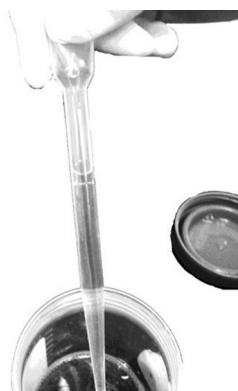
Figura 4. Aspirazione fino alla tacca sulla pipetta
