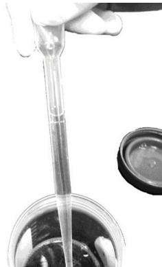
Abbildung 4. Aspirieren bis zur Linie auf der Pipette
