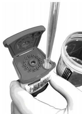
Abbildung 5. Dispensieren der dekontaminierten verflüssigten Probe in die Probenkammer der Kartusche
