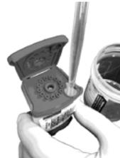
図 5. 液化済み検体を試薬カートリッジに添加する
