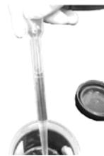
図 4. 検体をピペットの線まで (2mL 以上) 吸引する。
