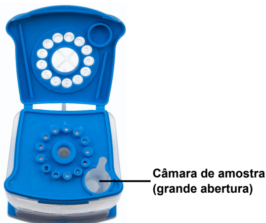
Figura 1. Cartucho do Xpert MRSA/SA SSTI (vista de cima)
