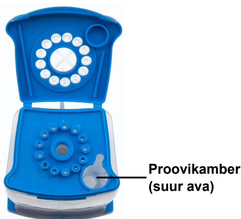
Joonis 1. Xpert MRSA/SA SSTI kassett (ülaaltvaade)
