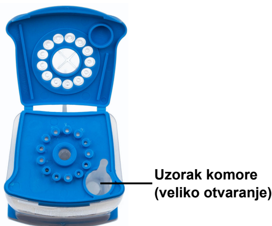
Slika 1. Uložak Xpert MRSA/SA SSTI (pogled odozgo)
