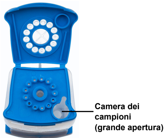
Figura 2. Cartuccia del test Xpert Bladder Cancer Monitor (vista dall'alto)
