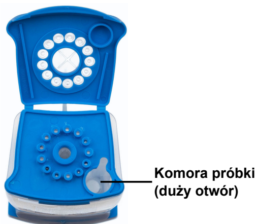
Ilustracja 5. Xpert Xpress SARS-CoV-2/Flu/RSVKartridż testu (widok z góry)
