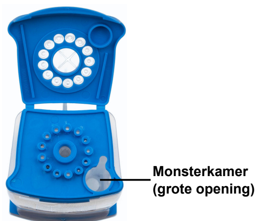
Afbeelding 5. Xpert Xpress SARS-CoV-2/Flu/RSV-cartridge (bovenaanzicht)
