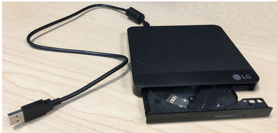
6. attēls. Komplektā iekļautais DVD diskdzinis, parādīts ar atvērtām ievietošanas durtiņām.
