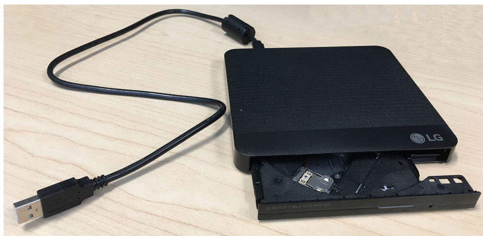
Afbeelding 6. Geleverd dvd-station, weergegeven met geopende laaddeur
