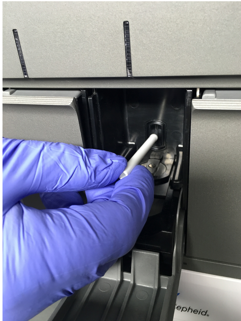
Figure 85. Insertion de la brosse de nettoyage dans la fente du module I-CORE
