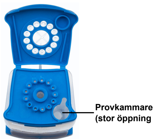
Figur 5. Xpert Xpress SARS-CoV-2/Flu/RSV Kassetten (vy från ovan)
