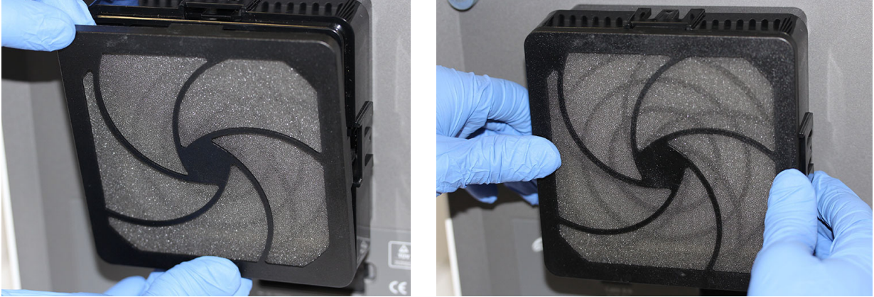
9-31. ábra Az előszűrő és az előszűrő rögzítőelemének cseréje
