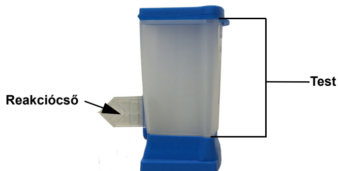
5-27. ábra A kazetta testét és reakciócsövét bemutató ábra
