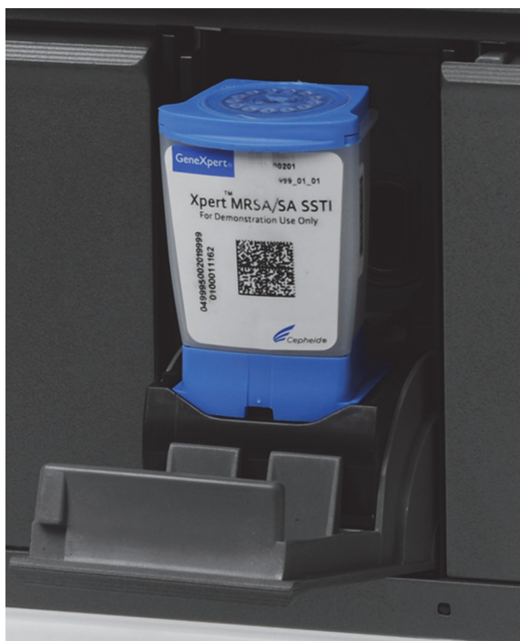
5-29 pav. „GeneXpert“ Kasetė, atremta į modulio skyriaus pagrindo nugarėlę
