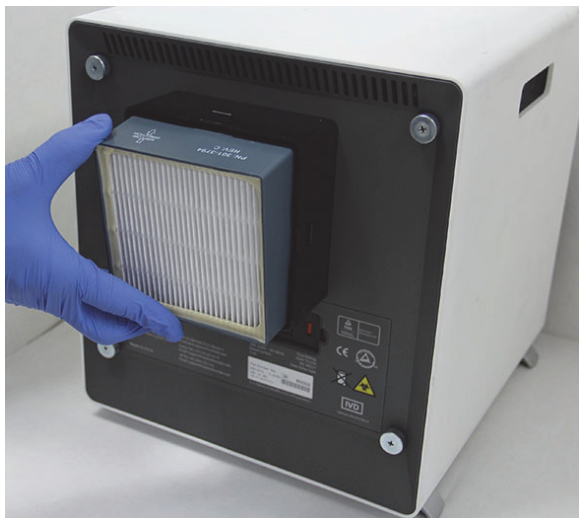
9-29 pav. DV filtro keitimas
