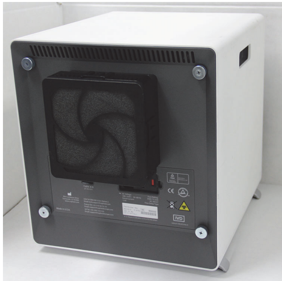
9-24 pav. „GX-IV“ prietaisas, pritaikytas prieigai prie filtro
