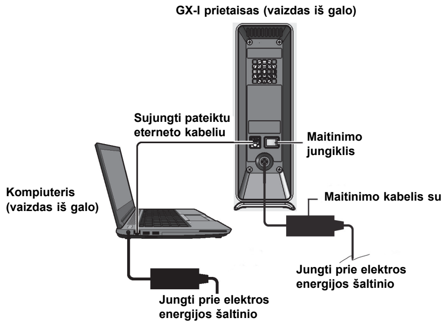
2-5 pav. GX-I prietaiso prijungimas prie nešiojamojo kompiuterio
