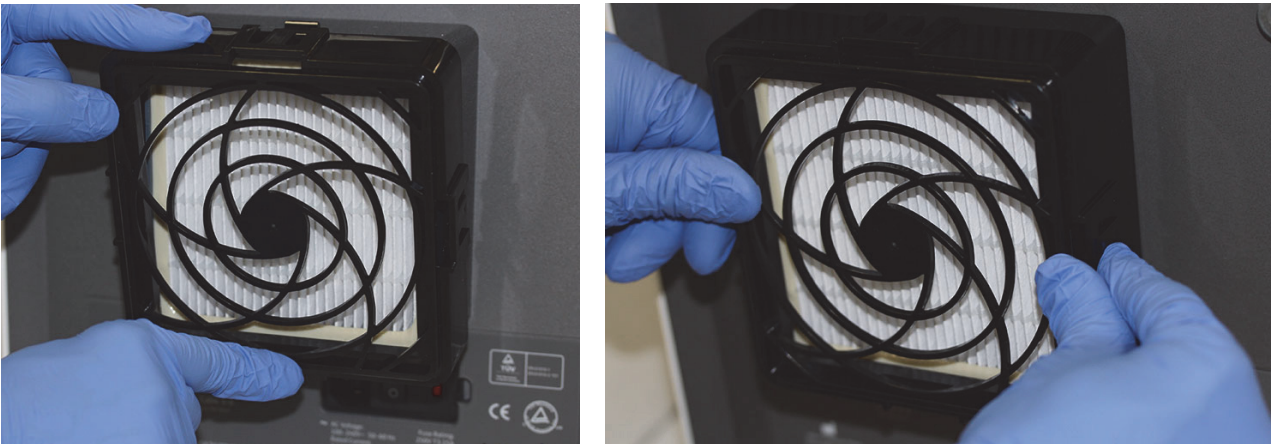
9-30 pav. DV filtro laikiklio keitimas
