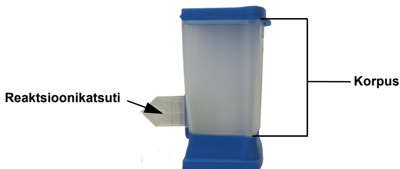
Joonis 5-27. Kasseti korpus ja reaktsioonikatsuti
