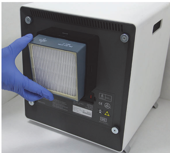
Joonis 9-29. HE-filtri vahetamine
