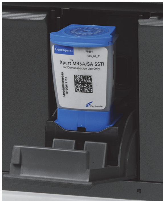
Joonis 5-29. GeneXperti kassett, mis on asetatud mooduli lahtri pörandale kannu juurde
