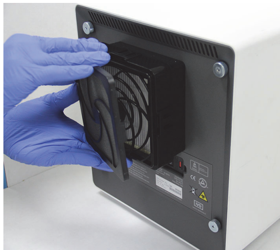
图 9-25. 取下预滤棉固定框
