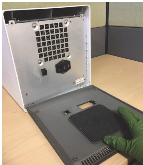
图 9-16. 更换较老款 GX-IV 内的防尘泡沫
