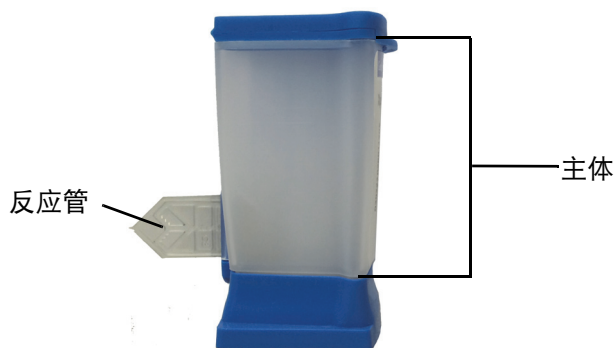
图 5-27. 显示出主体和反应管的样品匣
