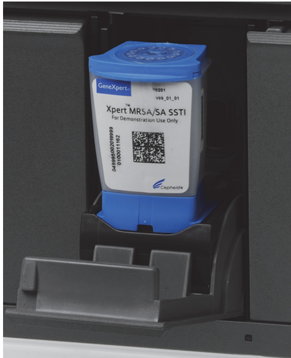
图 5-29. GeneXpert 样品匣位于模块仓底部的跟部
