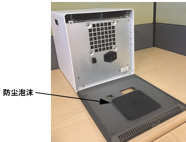
图 9-15. 老款 GX-IV 内的防尘泡沫
