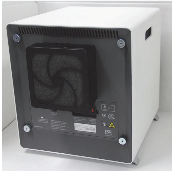
图 9-24. GX-IV 仪器调整到便于操作过滤器的位置
