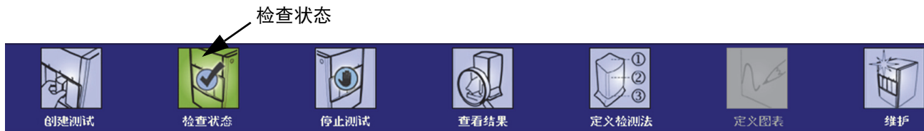
图 9-41. “检查状态”按钮正常（对号符号）
