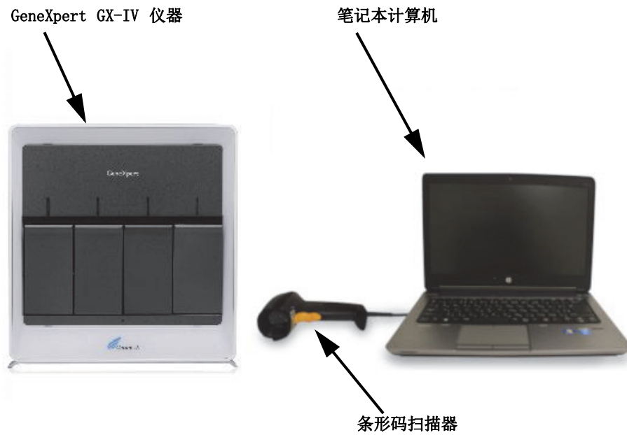
图 1-6. GeneXpert GX-IV 硬件组件（以笔记本电脑示例）
