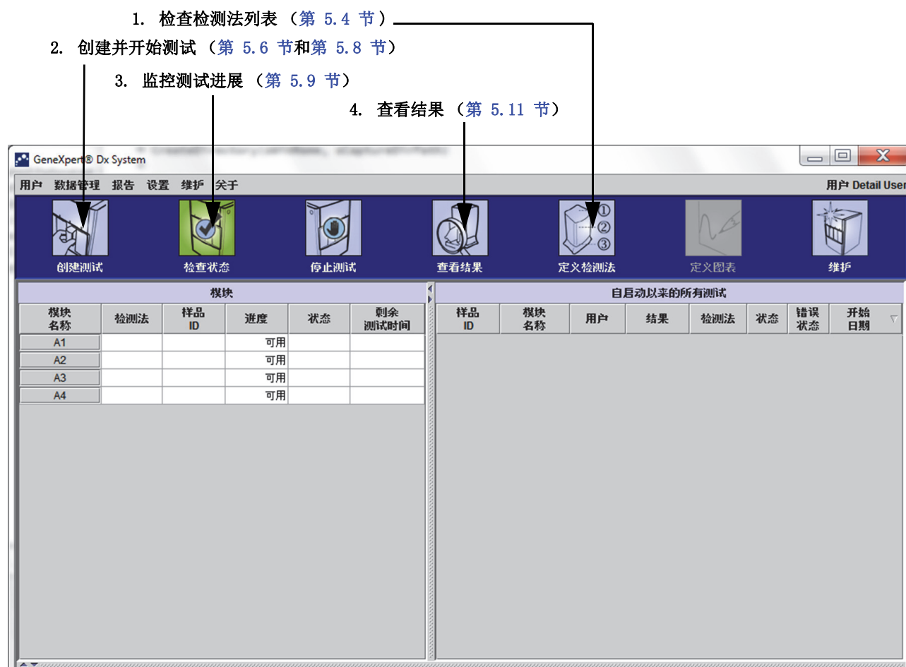
图 1-12. GeneXpert Dx System 窗口和典型测试工作流程
