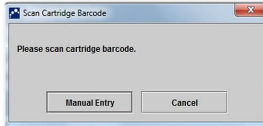
**3** Отсканируйте штрих-код, направляя лазер сканера с расстояния от 20 до 25 см на изображение штрих-кода
